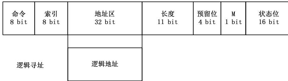
EtherCAT 逻辑寻址结构
