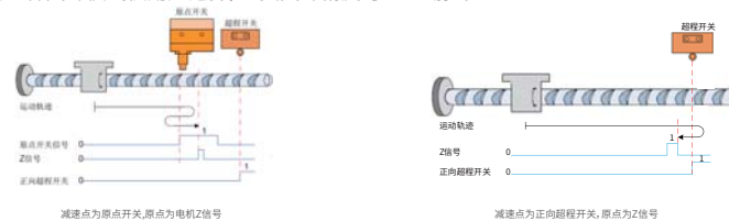
减速点为原点开关,原点为电机Z信号
